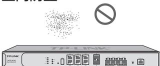
灰尘落在多业务安全网关表面会造成静电吸附,使金属接点接触不良。虽然设备本身在防静电方面做了一定措施,但当静电超过一定强度时,仍会对内部电路板上的电子元器件造成致命的破坏,为避免静电影响设备正常工作,请注意以下事项:
